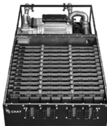
Рис. 4 Вычислительный блок реконфигурируемого суперкомпьютера с погружной системой охлаждения
